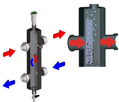
Sul separatore idraulico è già montata una valvola di ritegno per permettere la disinstallazione della valvola sfogo aria per effettuare interventi di manutenzione ordinaria. Nella parte inferiore vi è un attacco da 1/2" dove va installato il rubinetto di scarico per l'eliminazione dei fanghi accumulatisi sul fondo. L'attacco frontale da 1/2" permette l'installazione di manometri o termometri.
